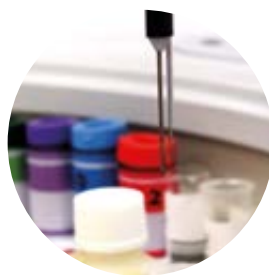
Aguja con Mezcla y Sensores de Impacto
