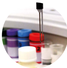
Aguja con Mezcla y Sensores de Impacto
